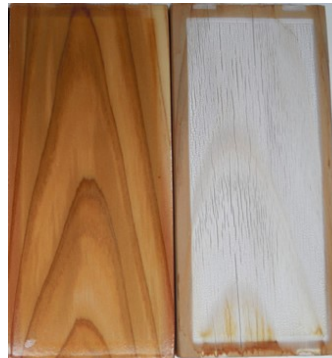
【モーエンタフ塗装】 杉材 促進耐候試験 1,000 時間 塗膜の劣化は無く、光沢を保っている。
