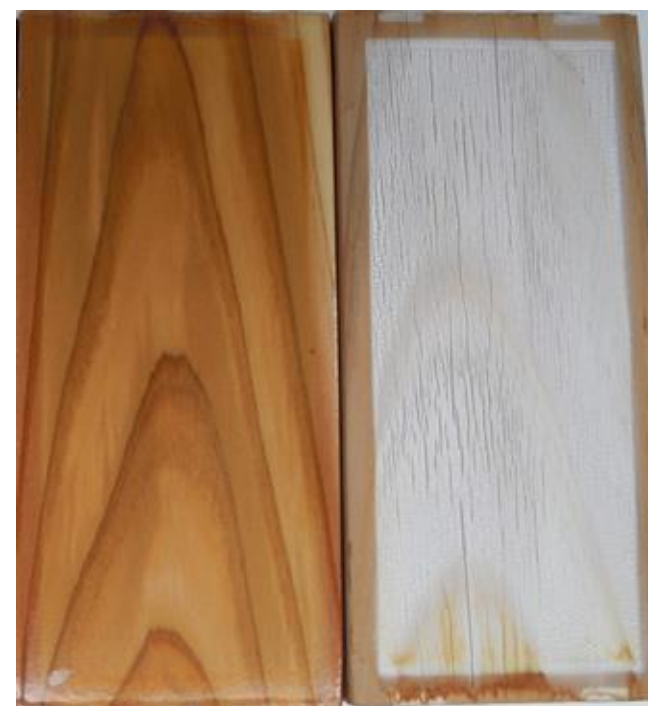
【モーエンタフ塗装】 【無塗装】 杉材 促進耐候試験 1,000 時間 塗膜の劣化は無く、光沢を保っている。
