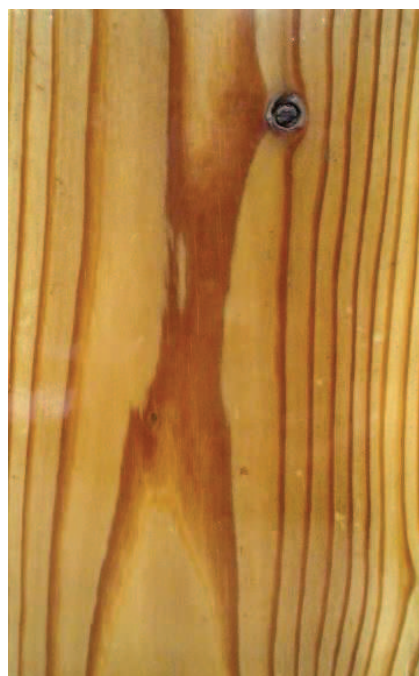
カラマツ材 屋外曝露 3 年間 塗膜の割れ・膨れ・剥がれ・ 白化等の劣化は見られない。
