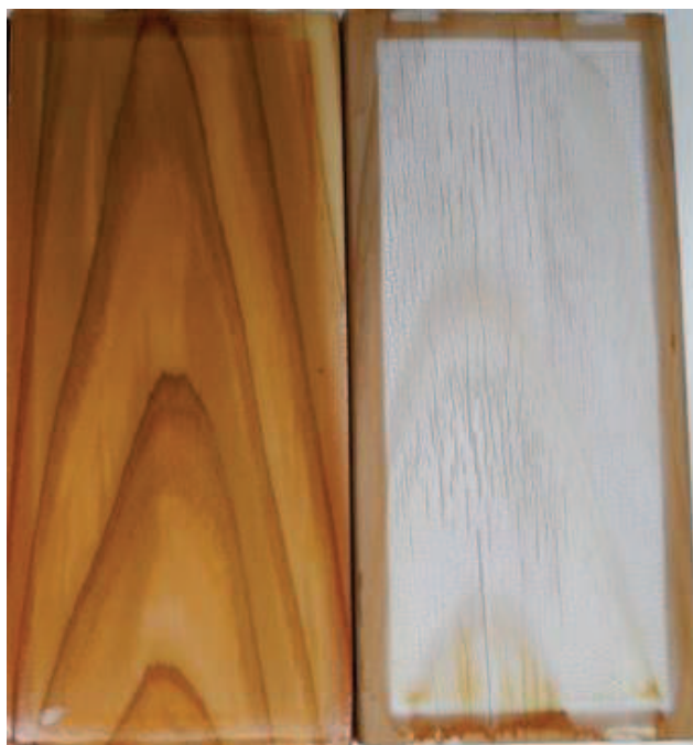
【モーエンタフ塗装】 【無塗装】 杉材 促進耐候試験 1,000 時間 塗膜の劣化は無く、光沢を保っている。
